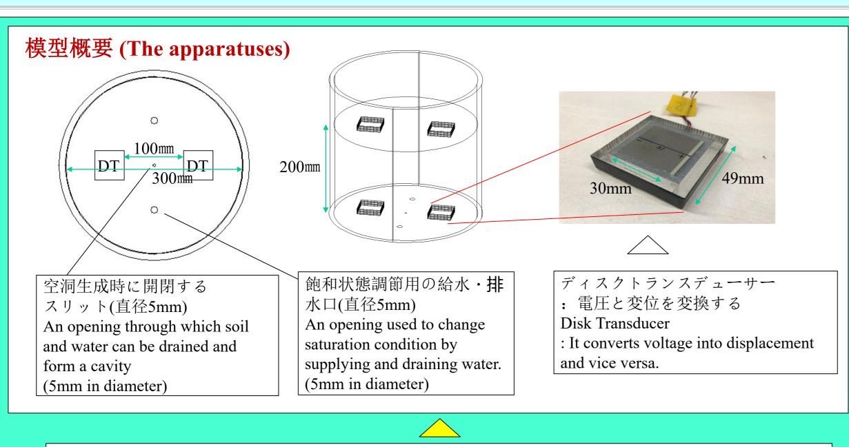
上部のDTから数nmの弾性波(2kHz-30kHz)を発生させ、下部のDTで受信する試験を以下の5通りの地盤状態で行う。
