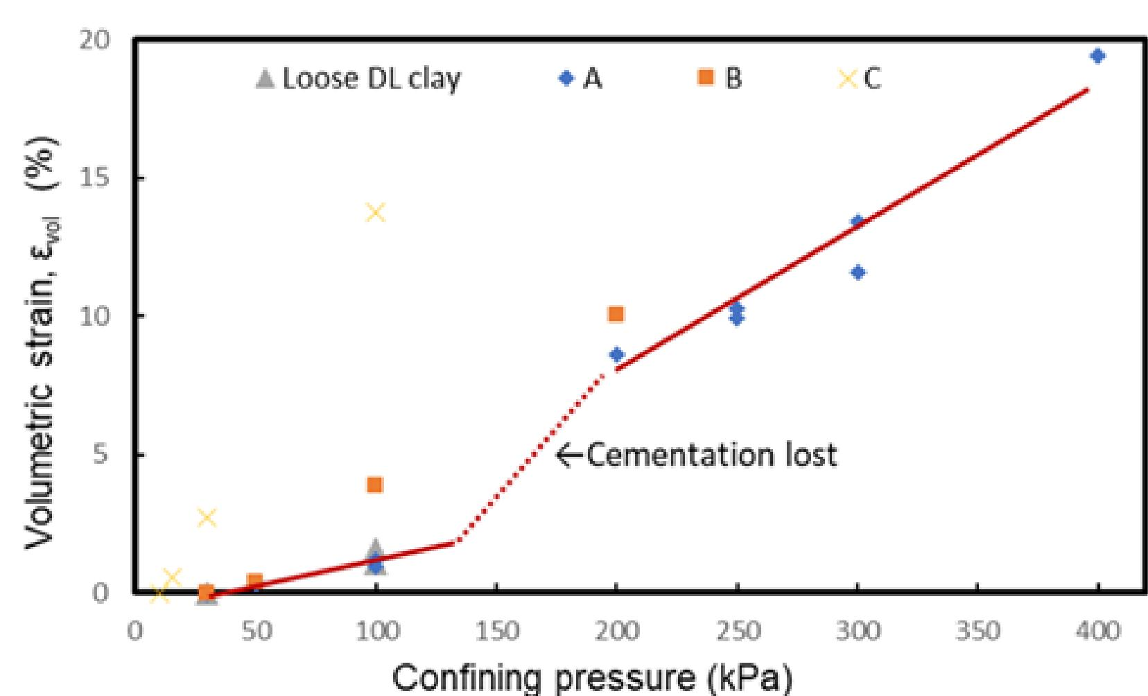
人工供試体Particle A のCD試験結果→
