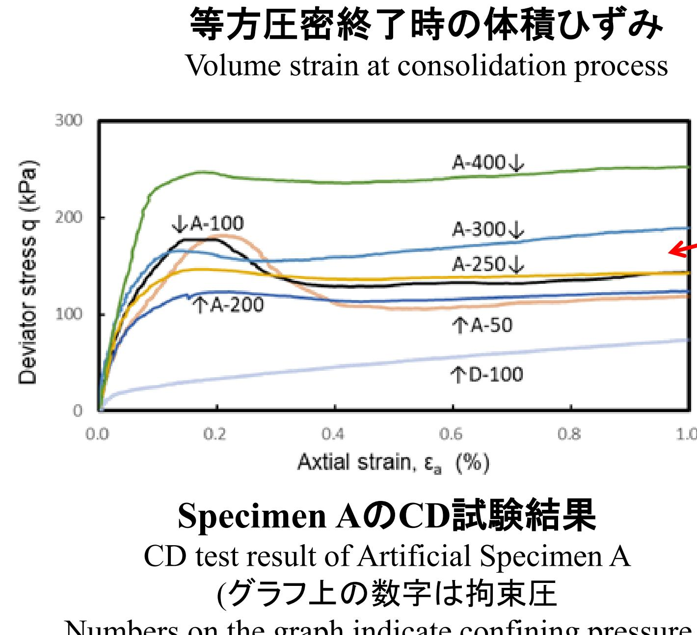
Specimen AのCD試験結果
