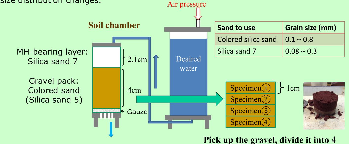
specimens, and conduct sieve test 粒度分布の変化によって細粒分の流入を観察する
