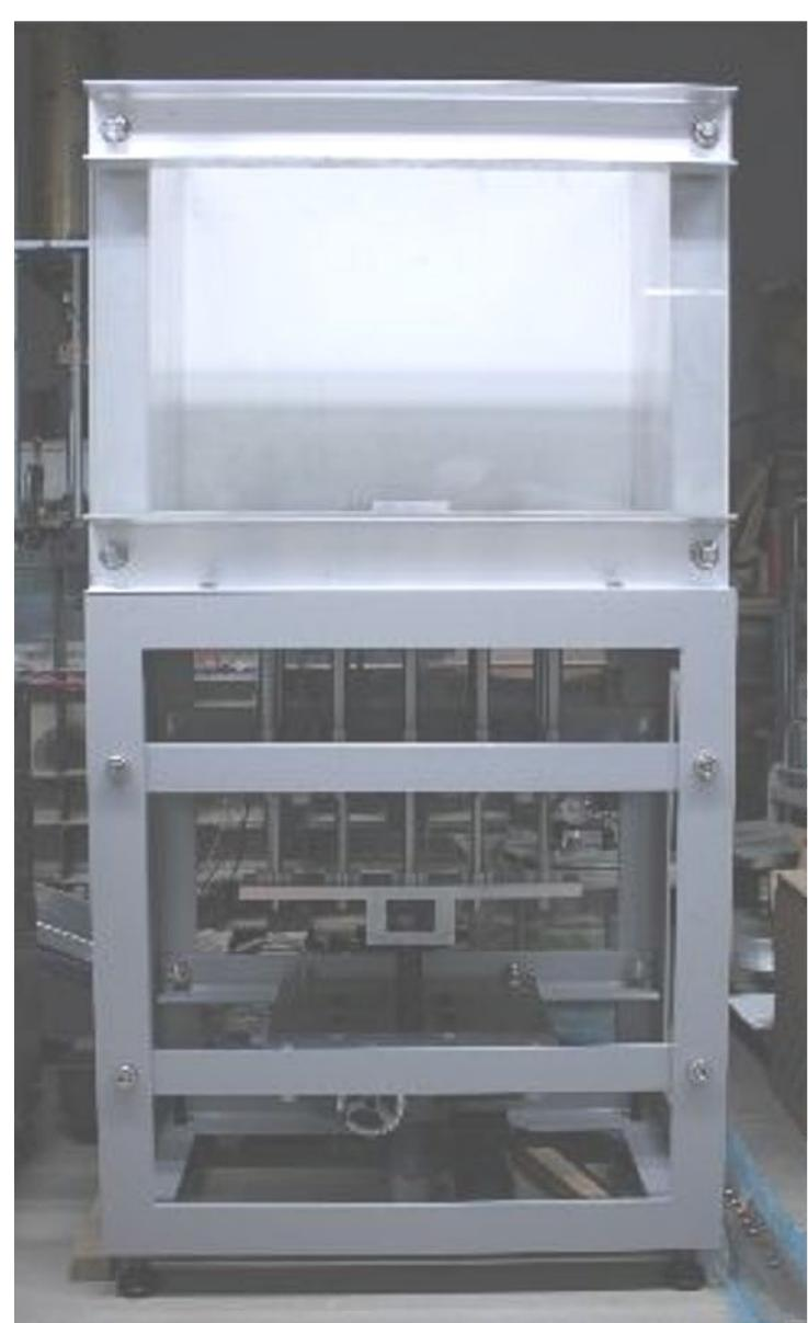
落とし戸試験装置 Trapdoor test apparatus
