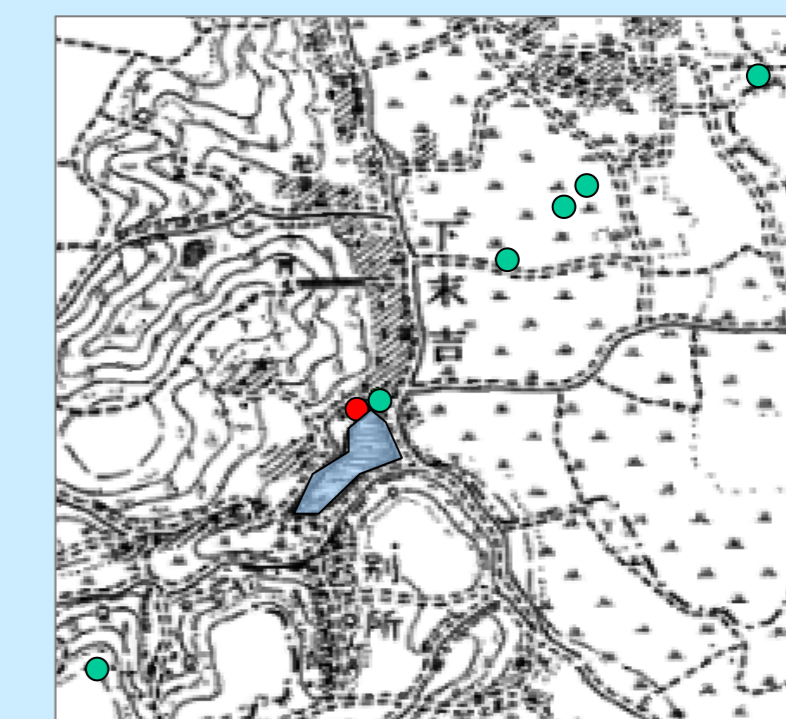
過去に池淵であった地点で発生した空洞 A cavity growth which occurred at the previous waterfront(1909). Modified from 「今昔マップ on the web」 ( http://ktgis.net/kjmapw/ )
