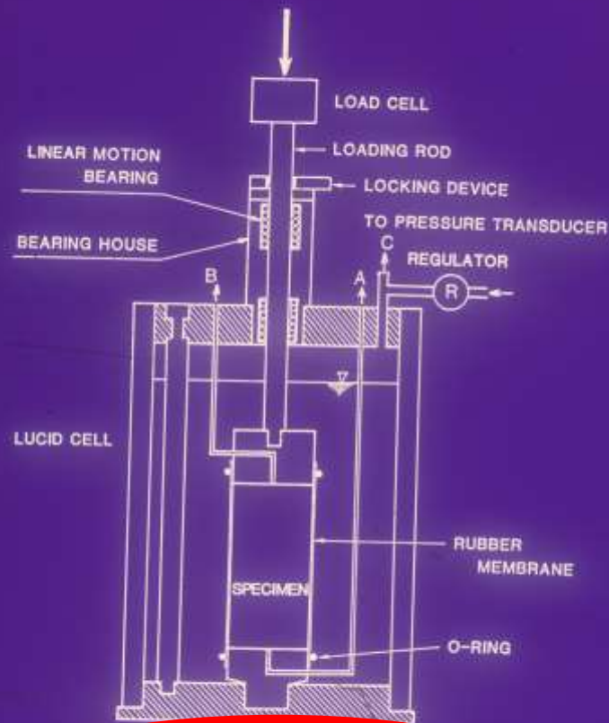
FIG.-3 試作した三軸セルの模式図
