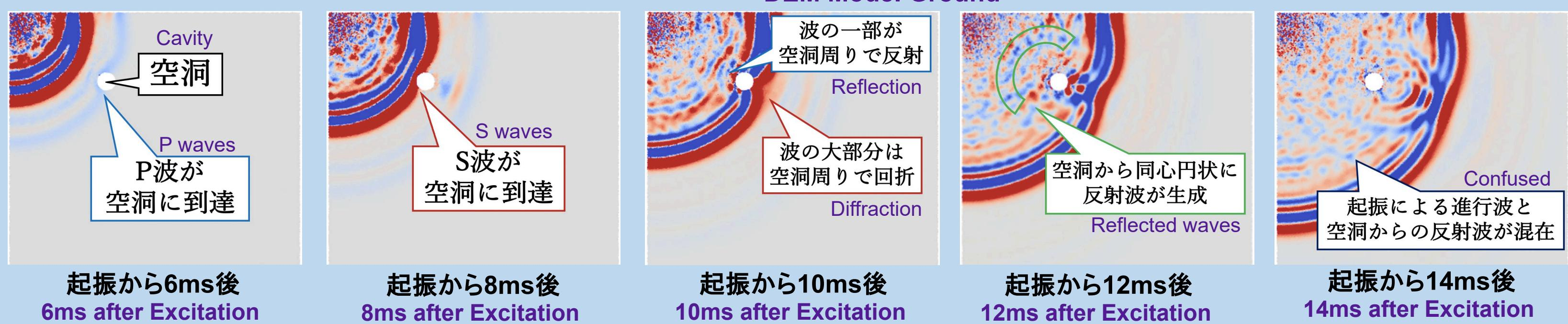
・起振領域と空洞直上の間の地表において、起振による進行波(図の右下向き)と空洞からの反射波(図の左下向き)が混在。
