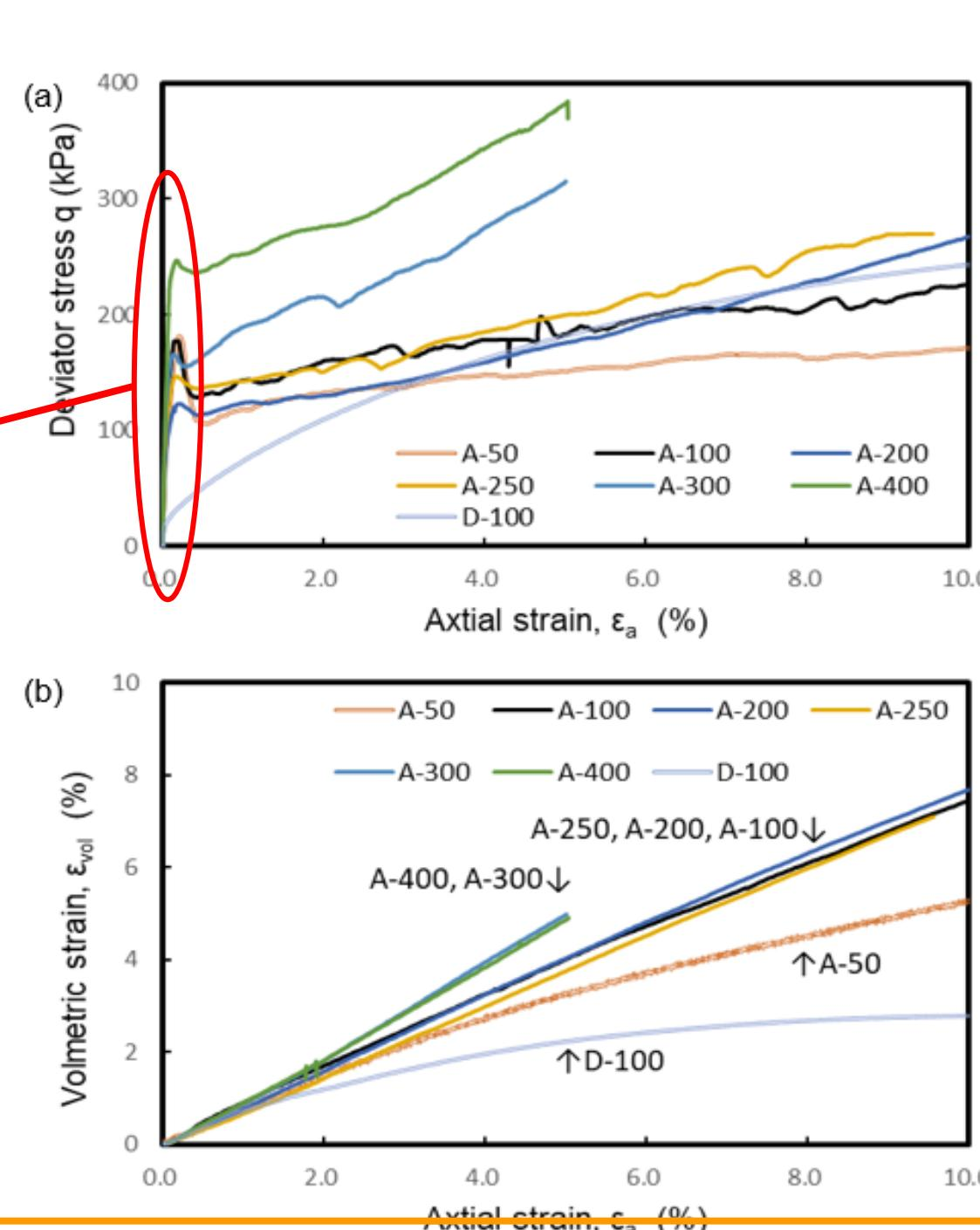
Specimen AのCD試験結果
