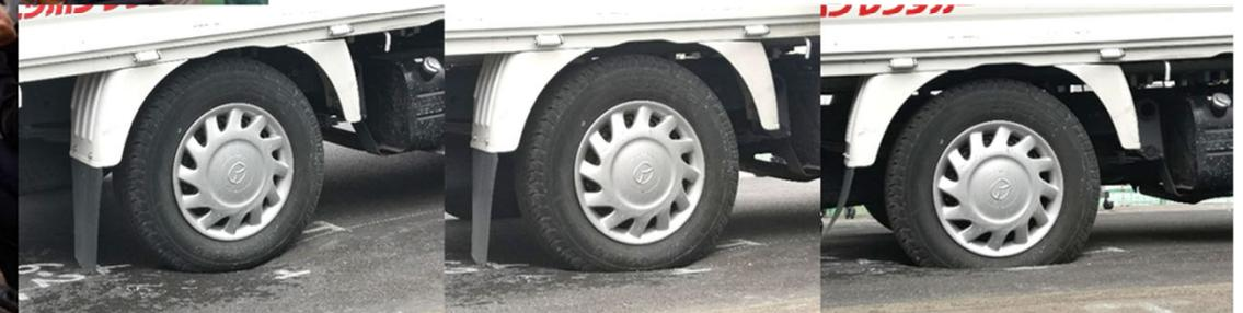
見学会：実物大試験道路における陥没試験(車両後輪直下に空洞あり)
