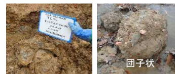
旧市道盛土 横断管吐口の土砂
