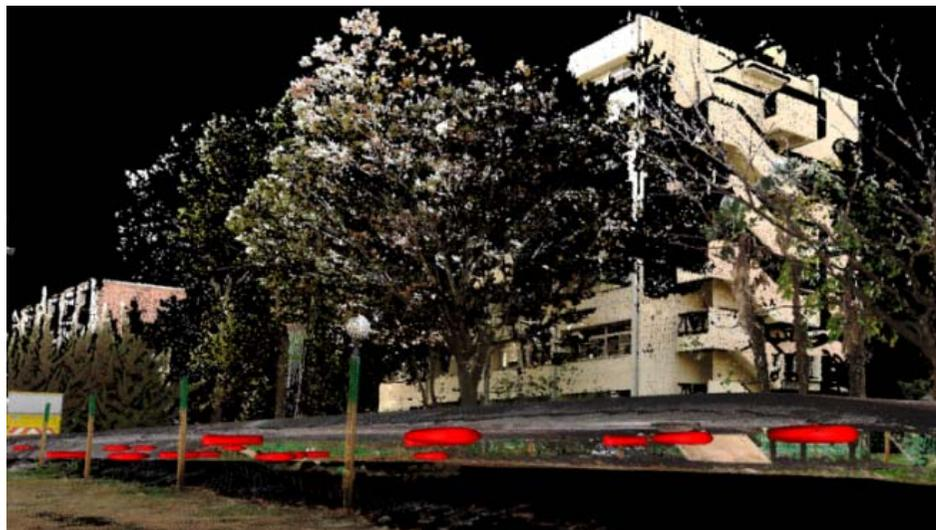
実物大試験道路の点群+空洞三次元合成画像
